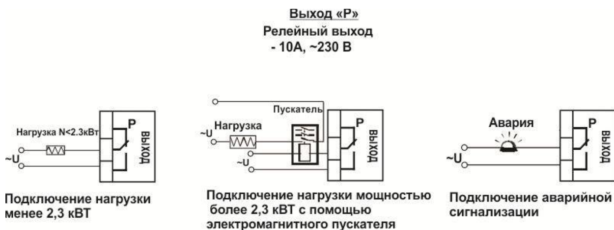
Рисунок 9 – Схемы подключения релейных выходов.
